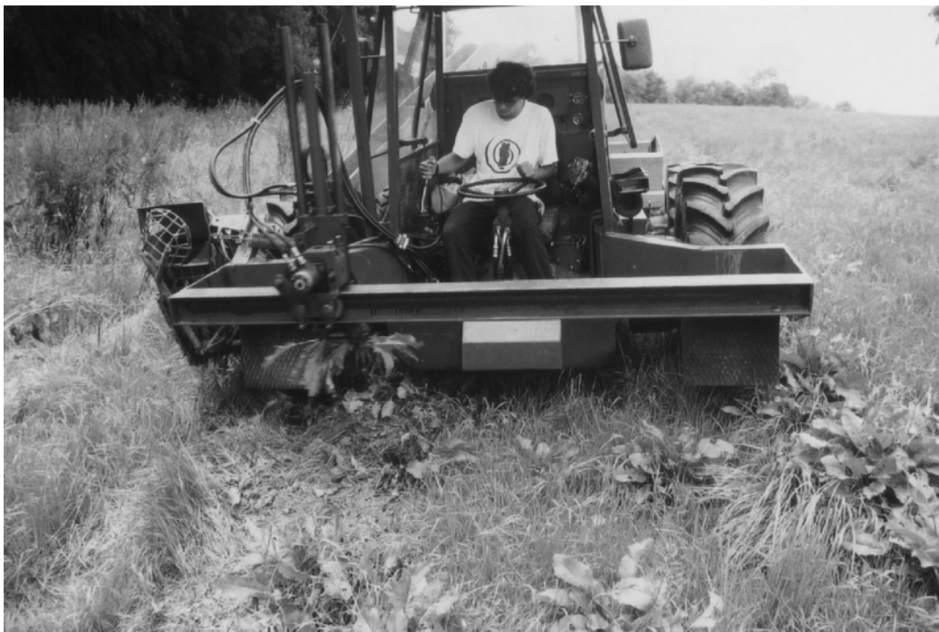
Bild 1. Halbautomatisches Wurzelziehgerät für Ampfer (WUZI); Prototyp aus Österreich
