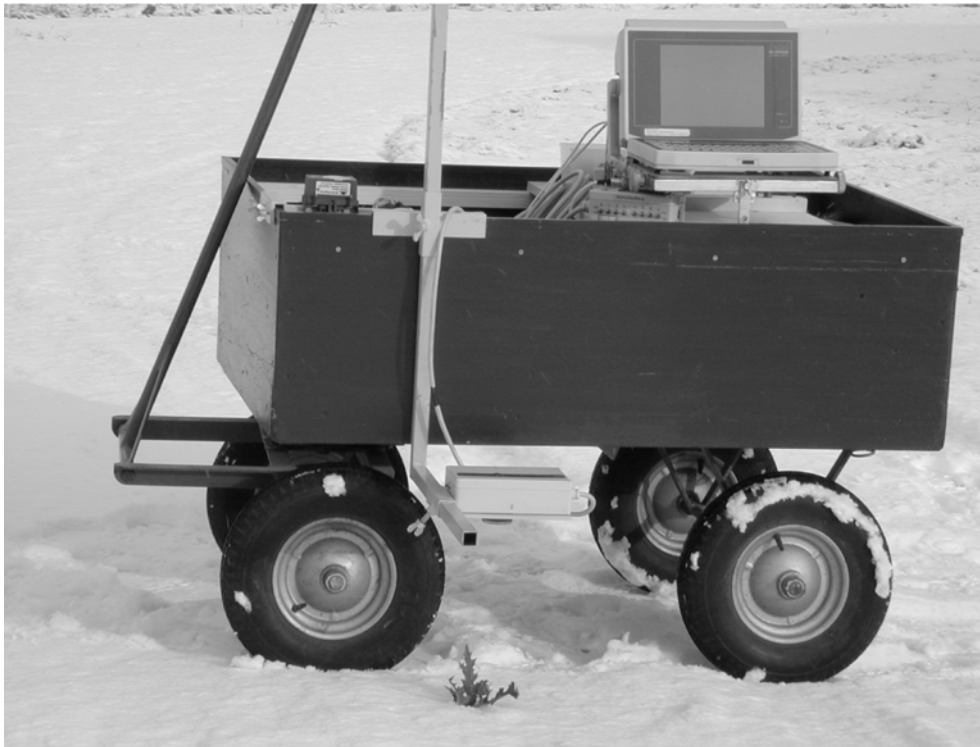
Bild 5. Messwagen für die Erfassung der Reflexion verschiedener Pflanzen auf dem Feld
